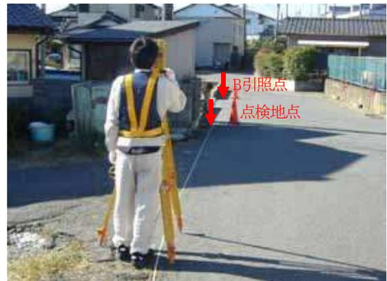
A引照点でのTSによる視準 (A引照点～点検地点～B引照点)
