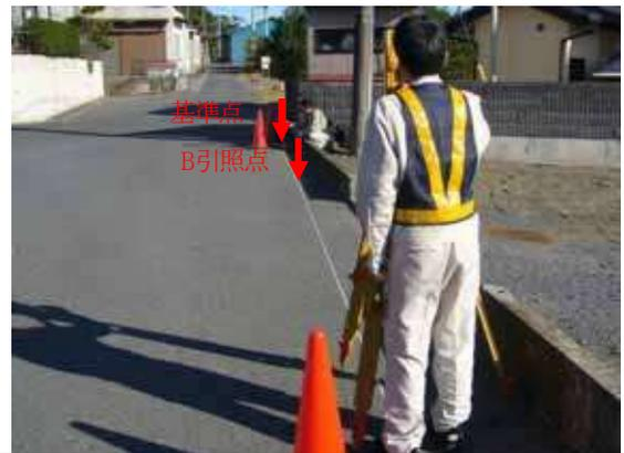
A引照点でのTSによる視準(A引照点～B引照点～基準点)
