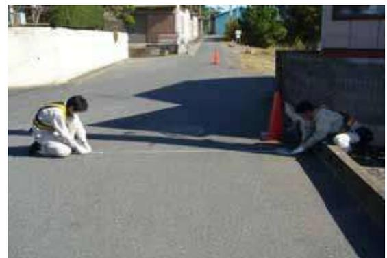
水平距離の測定 (D引照点～基準点)
