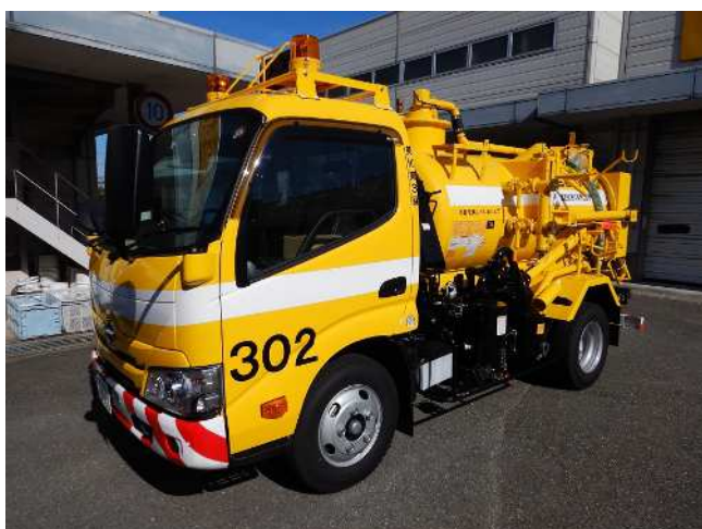
バキュームダンパー車 (汚泥吸引用)
